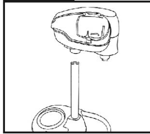
Наденьте основной блок на штатив, нажмите двумя руками для полного закрепления.
