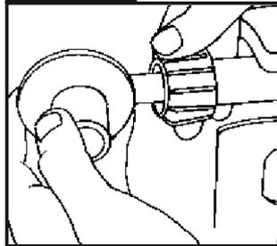
Убедившись, что газовый баллон закрыт, присоедините шланг с редуктором от установки к газовому баллону. Делайте это
