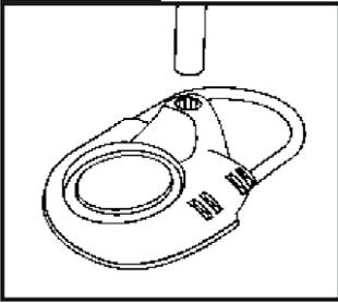
Поставьте подставку на ровную поверхность верхней стороной вниз. Вставьте U-образную трубку в отверстие на подставке до щелчка.
