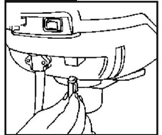
Присоедините разъем питания в гнездо, расположенное на задней части основного блока.
